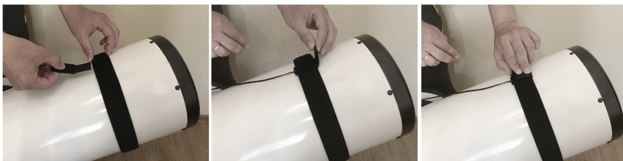
Рис. 3 Пример установки датчика на телескопы ШК, МАК или рефрактор.
